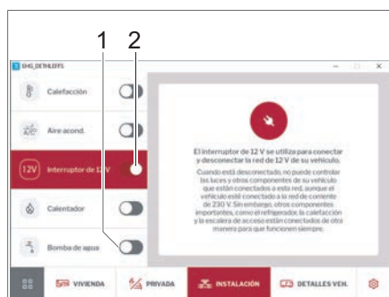
Fig. 263 12 V y bomba de agua
