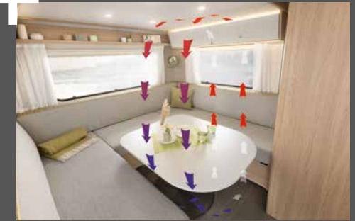
AirPlus: sistema de circulación de aire detrás de los armarios altos
