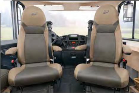
Cómodos asientos tipo piloto con regulación de la inclinación y la altura y apoyabrazos acolchados
