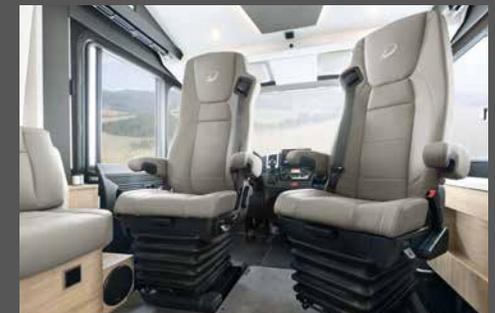
Viaje de primera con asientos de cabina de suspensión neumática con absorción de impactos, calefactados y ventilados (opcional).
