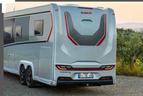
Trasera de GFK, tipo automóvil, con excelente aislamiento; la cámara de marcha atrás y la tercera luz de freno quedan perfectamente integradas.
