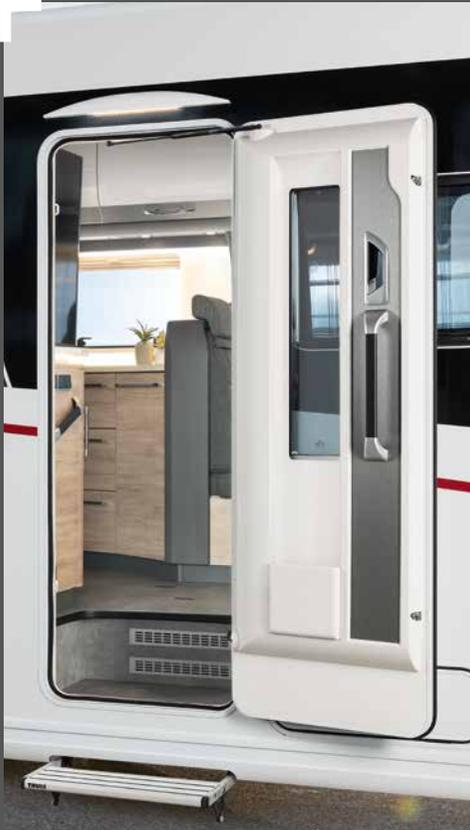
Puerta de 70 cm de ancho con ventana, cierre centralizado y asistente electrónico de cierre.
