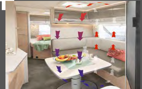
AirPlus: sistema de circulación de aire detrás de los armarios altillos
