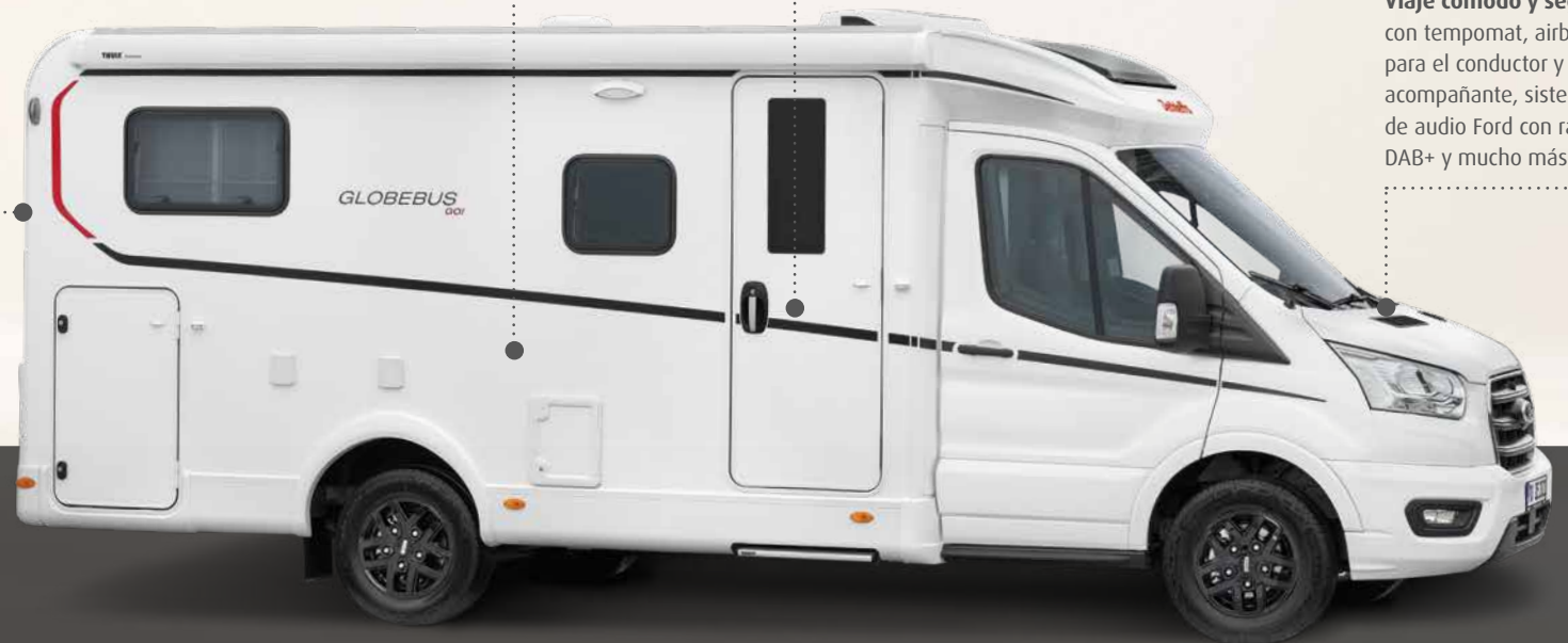
Techo, trasera y paredes laterales de GFK resistente
