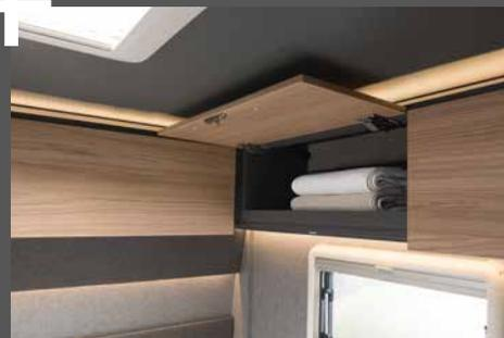
En los armarios altillos caben muchas cosas. El sistema de circulación de aire por detrás de los armarios altillos AirPlus evita la formación de agua de condensación a bajas temperaturas.
