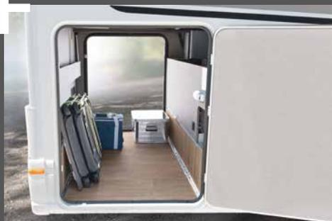
El amplio garaje trasero dispone de doble portón accesible fácilmente con una mano. Equipa toma de luz, enchufe de 230 V y un total de tres guías de sujeción.
