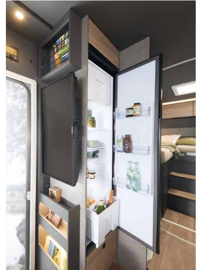
El frigorífico con congelador de 137 l está colocado en posición elevada para tenerlo todo a mano. Equipado con el sistema AES, selecciona de forma autónoma el tipo de energía óptimo (12 V, 230 V o gas).
